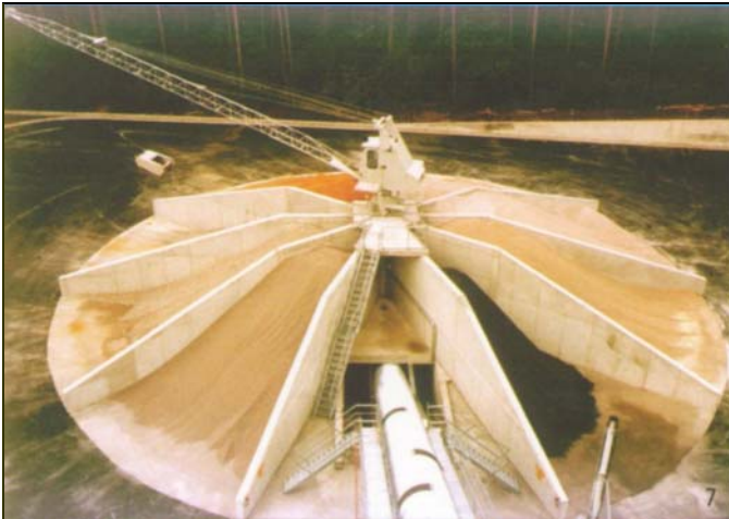
Рис. 1 Компактное хранилище материалов для растворобетонного узла MIXOMAT THZ с полностью автоматическим скреперным механизмом типа THS 60/22
