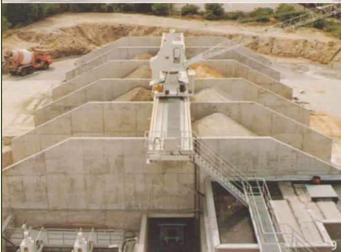
Рис. 7 Компактное хранилище материалов для бетоносмесительного узла MIXOMAT THZ3000 B1-S8 с полностью автоматическим скреперным механизмом типа THS 60/22
