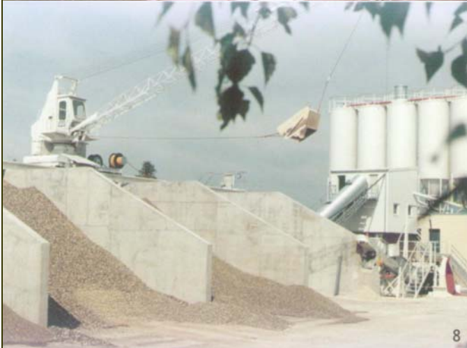
Рис. 4 Компактное хранилище материалов для растворобетонного узла MIXOMAT THZ2250 B1-S4 с полностью автоматическим скреперным механизмом типа THS 40/22
